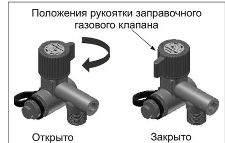
2. Отвинтите вентиляционный винт. Закройте заправочный газовой клапан, открутите винт, чтобы выпустить остаточное давление газа. Необязательно выкручивать полностью винт заправочного газового клапана.
