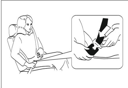
5. Поясничный ремень должен проходить внизу и облегать бедра, не смещаясь на талию. В случае столкновения правильное положение данного ремня обеспечивает распределение нагрузки на тазобедренную часть тела и исключает воздействие на брюшную полость, предотвращая тяжелые повреждения внутренних тканей и органов.
