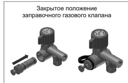
7. Вентиляционный винт. Закручивайте вентиляционный винт до упора.
