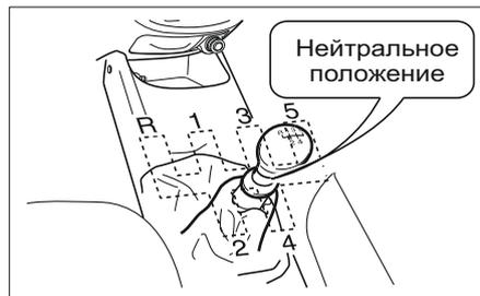
5. Не нажимая на педаль акселератора, поверните ключ зажигания в положение **START** и после запуска двигателя отпустите ключ. Если двигатель запускается, но снова глохнет, то перед следующей попыткой запуска выждите **10** секунд.
