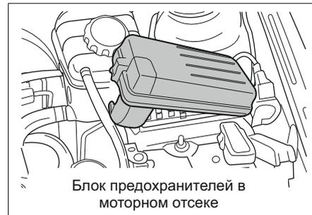
Блок предохранителей в моторном отсеке
