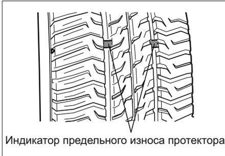
Индикатор предельного износа протектора
