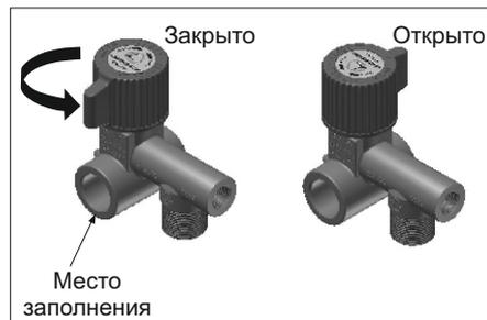
5. Закрыть заправочный газовой клапан. Перед снятием заправочного газового пистолета, после заправки, закройте заправочный газовой клапан.
